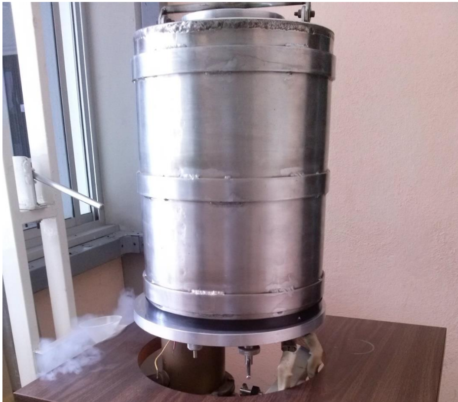
Figura 299. Proceso de evaporación de aluminio.
