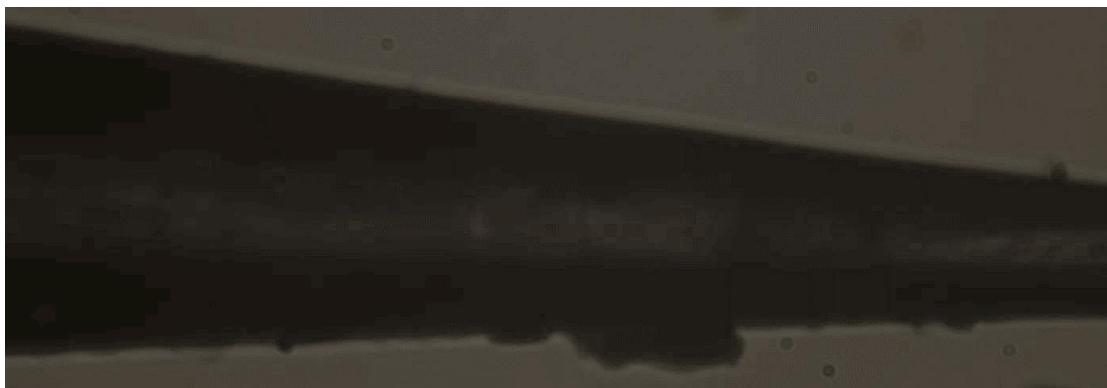
Figura 301. Fibra con suciedad incrustada.
