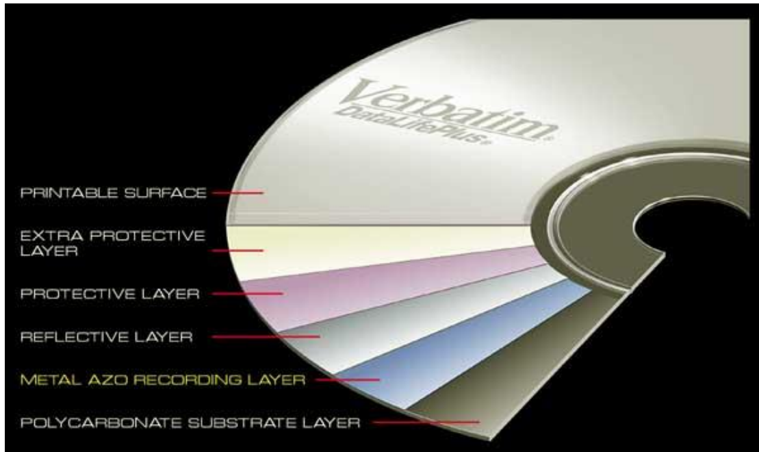
Figura 106. Estructura de un disco compacto Verbatim con superficie imprimible.
