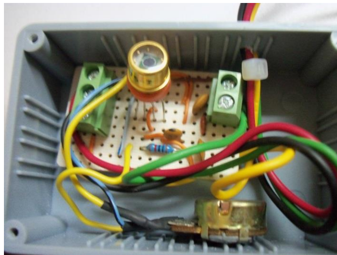
Figura 15. Electrónica desarrollada para el fotodiodo detector.
