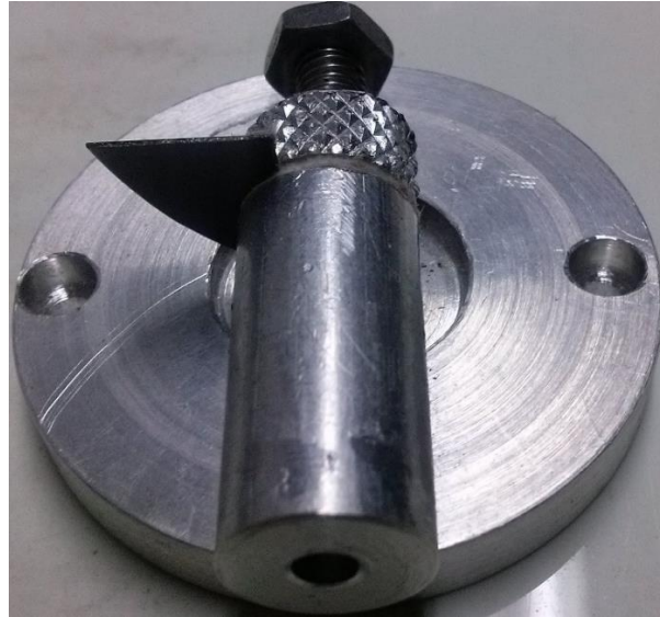
Figura 59. Muestra montada en la base vertical eje Z.
