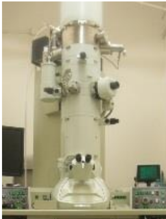
Figura 4.5.1.2. Imagen del (HR-TEM) JEOL 2010F. University of Texas at San Antonio.
