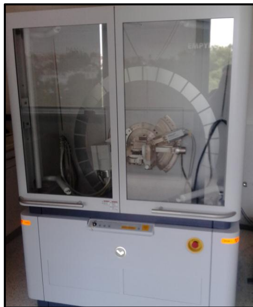
Figura 11. Fotografía del equipo de difracción de rayos X de alta resolución del CIACYT marca PANalytical.
