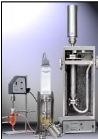
Figura 5 Imagen del equipo ultrasónico utilizado comúnmente para producir grafeno.
