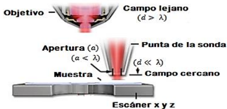
Figura 4.5. Configuración NSOM modo Reflexión [4,6].
