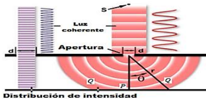
Figura 3.8. Efectos de fuente de luz coherente al pasar a través de aperturas de diferente ancho d [14].
