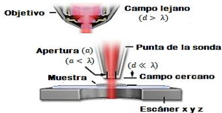
Figura 4.2. Configuración NSOM modo Colección, acercamiento [4,6].
