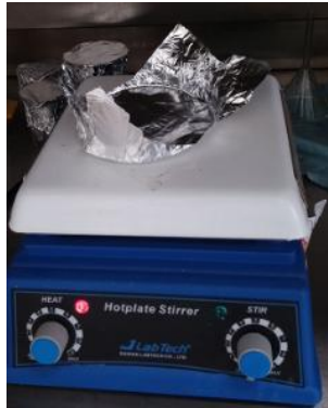
Figura 3.22. Hot-Plate empleado para el calentamiento de los sustratos
