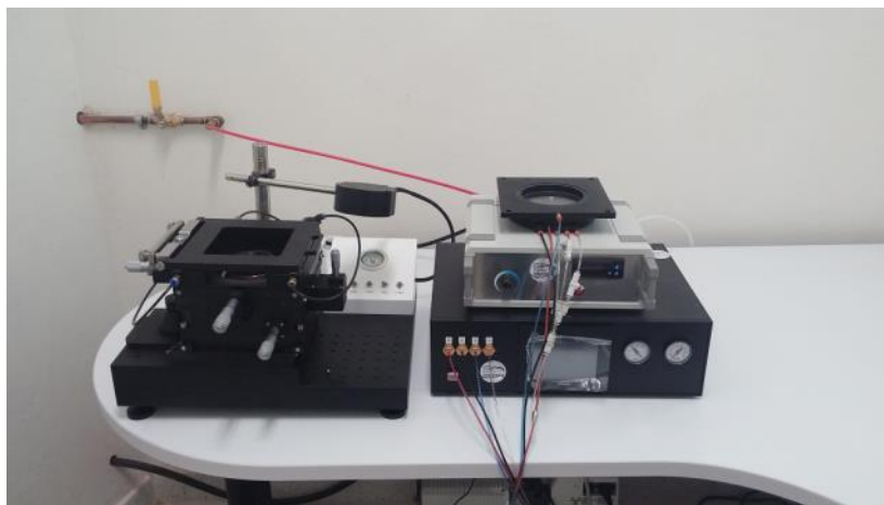
Figura 3.7: Equipo de nanoimpresión por UV
