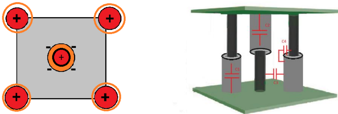
Figura 5.7: Esquema del capacitor de estructura matricial cuadrada compuesta de cilindros concéntricos.
