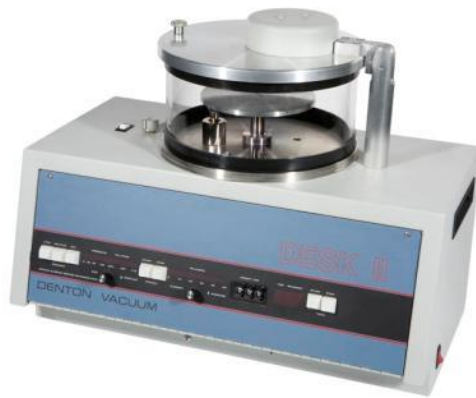
Figura 3.18: Equipo de Sputtering empleado
