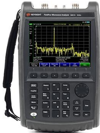
Figura 5.29: Equipo de Medición FieldFox N9917A.
