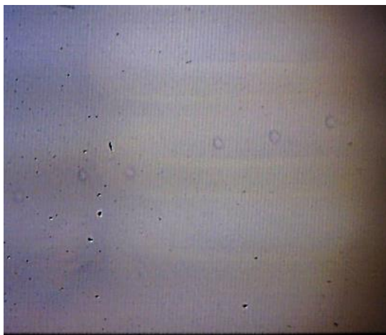
Figura 4.3: Nanoimpresión en resina Microposit SC 1827 empleando molde de CD sobre sustrato de Si
