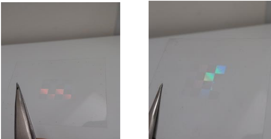
Figura 4.1: Nanoimpresión en I-UVP empleando molde del fabricante
