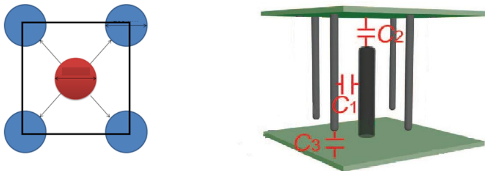
Figura 5.1: Esquema del capacitor de estructura matricial cuadrada
