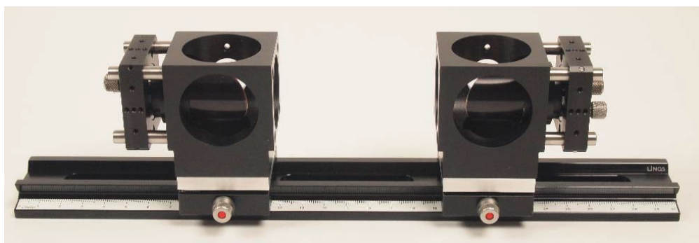
FIGURA 2.7: Riel metálico y herrajes para ajustar el camino óptico del espacio libre del espectrómetro THz-FDS
