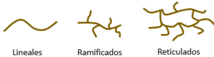
Figura 1.3.- Estructura de diferentes tipos de polímeros: (a) Lineal; (b) Ramificado; (c) Reticulado.
