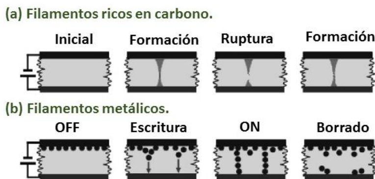
Figura 1.21.- Formación de filamentos; (a) Filamentos ricos en carbono y (b) Filamentos metálicos [40].
