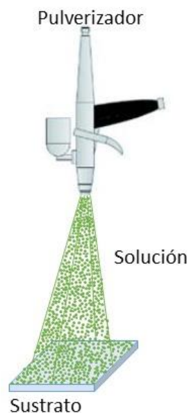
Figura 2.3.- Esquema de deposición por spray coating.
