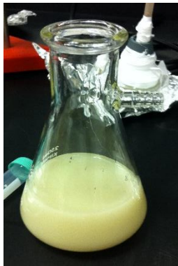
Figura 4.2 NPs-Ag en agua desionizada sintetizadas por el método de Turkevich.
