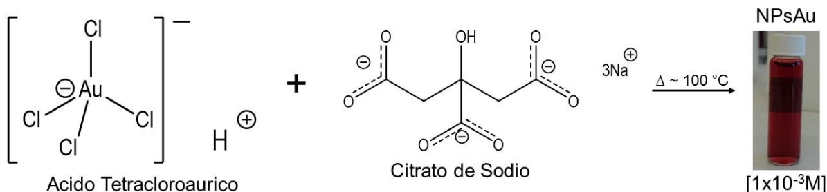
Figura 3.2. Reducción del ácido tetracloroaurico en presencia de citrato de sodio para la formación de NPsAu.
