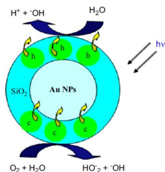
Figura 5.12. Mecanismo de acción fotocatalítica de sistemas de NPs Au@SiO 2 23
