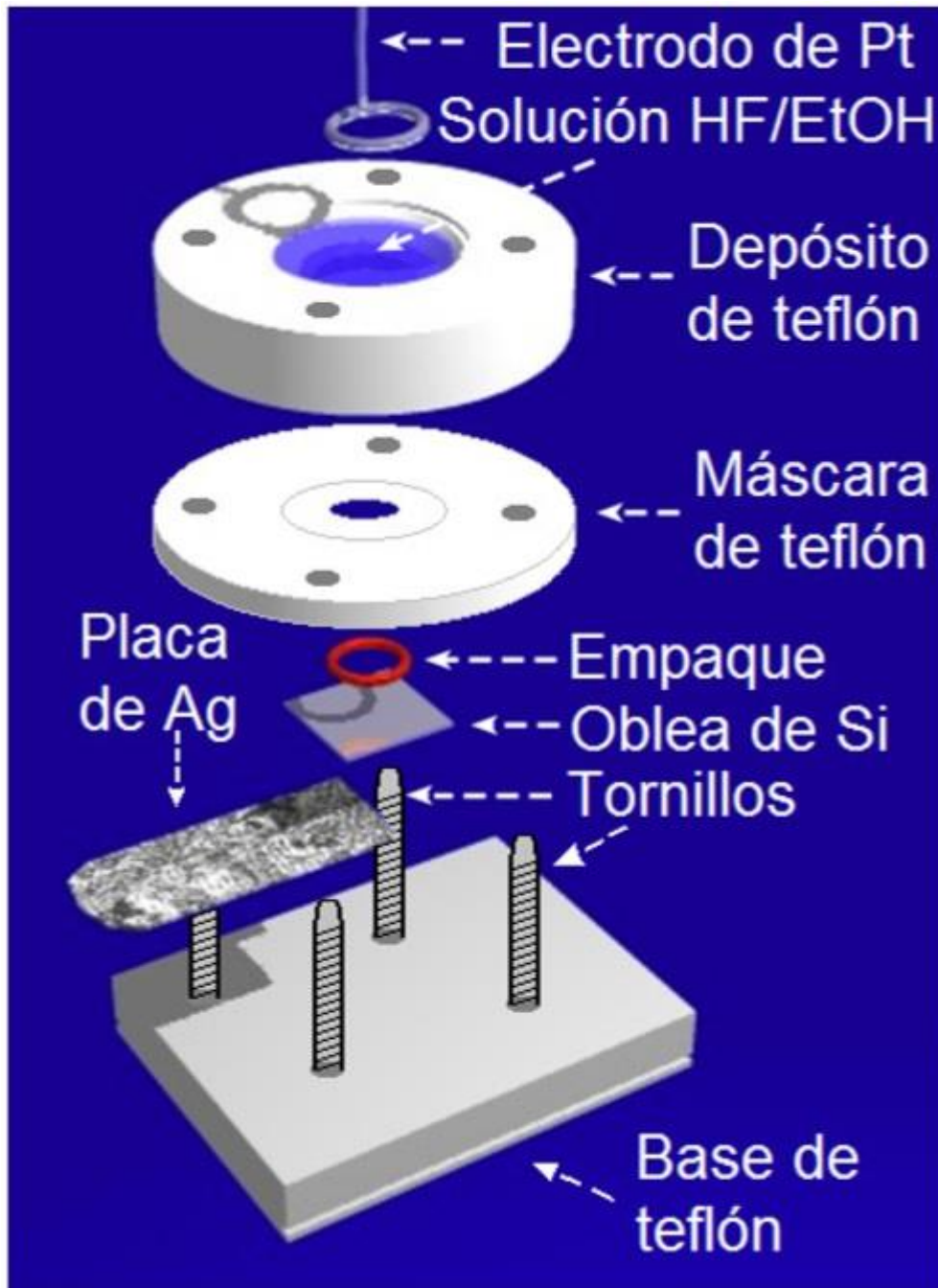
Figura 3.2. Esquema de la celda electrolítica utilizada en nuestro arreglo experimental.
