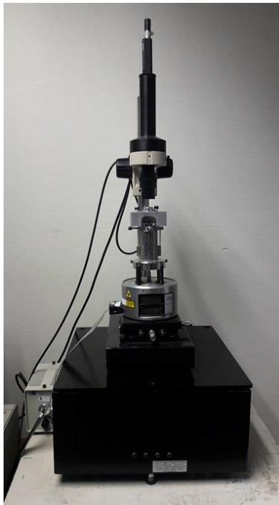
Figura 1.10. Sistema de microscopia de fuerza atómica mediante contacto utilizado.
