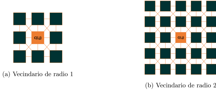
Figura 1.8: Vecindarios de 3 \times 3 y 5 \times 5 para cualquier célula C(i, j) perteneciente a la figura 1.7, a) r=1 y b) r=2
