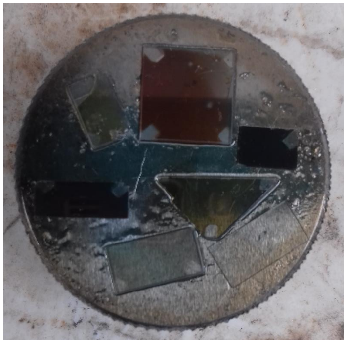
Figura 23. Montaje de las películas de GaN, InGaN, InN y el sustrato sobre un disco metálico.
