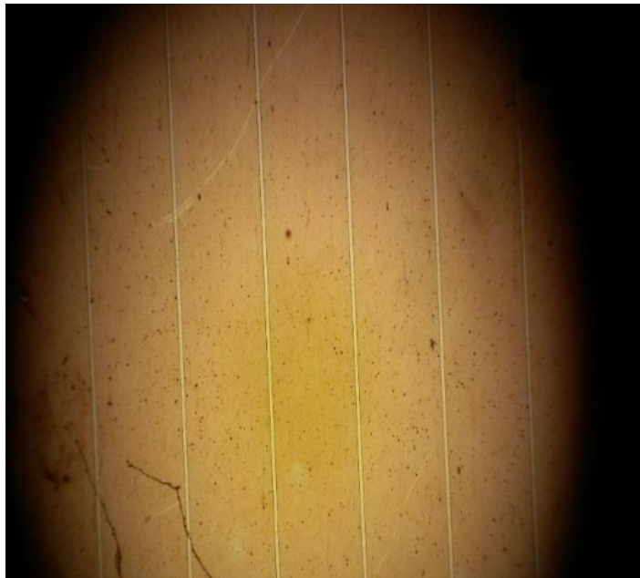
Figura 4.6 Canales totalmente abiertos en aluminio después del ataque químico.
