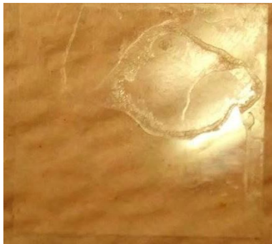
Figura 4.20 Spin on glass depositado sobre un sustrato con el spin – coater.
