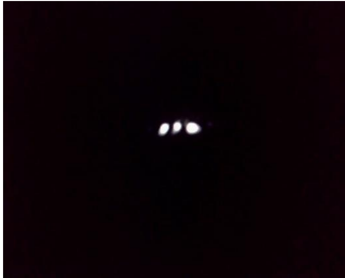
Figura 4.9 Patrón de irradiancia a la salida de la guía fabricada. Longitud de onda \lambda = 632.8nm con un ancho canal de \pm 17\mu m .
