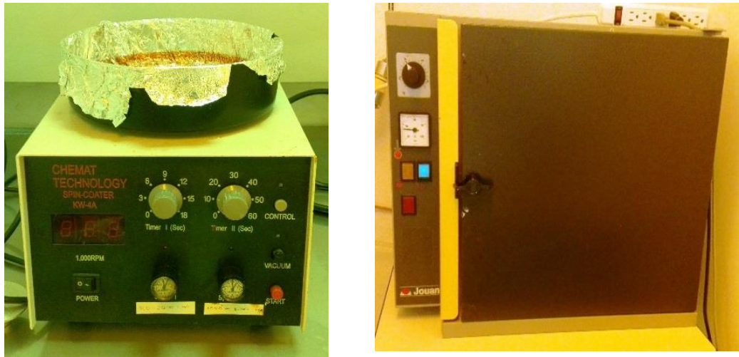
Figura 3.7 (a) Spin-Coater para el depósito de la fotoresina (b) horno eléctrico Jouan.
