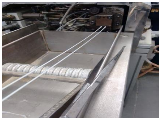
Figura 10. Extrusor utilizado en la elaboración de los hilos de los composites de LDPE/TiO 2 : a) panel de control, b) cañón del extrusor y termopares y c) salida del extrusor (hilos de LDPE/TiO 2 -SM-0.5%).
