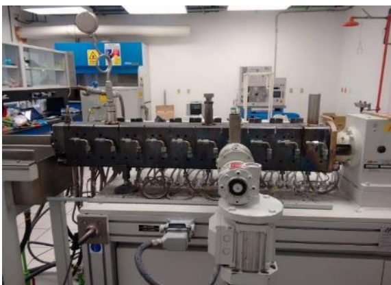
Figura 10. Extrusor utilizado en la elaboración de los hilos de los composites de LDPE/TiO 2 : a) panel de control, b) cañón del extrusor y termopares y c) salida del extrusor (hilos de LDPE/TiO 2 -SM-0.5%).
