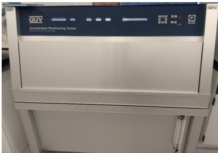
Figura 13. Cámara de interperismo usada en las pruebas de los diferentes compositos.
