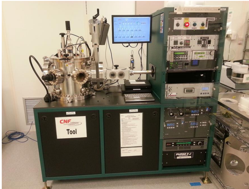
Figura 3.29. Sistema Sputtering para depósito de películas.
