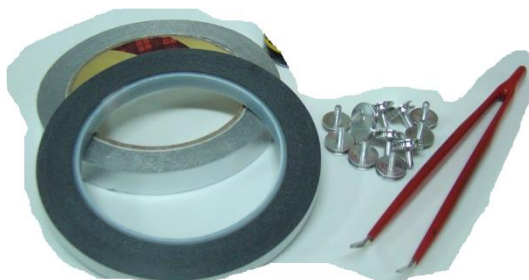
Figura 13. Cinta, pines y pinza. Utensilios requeridos para montar la muestra para analizar por caracterización SEM.
