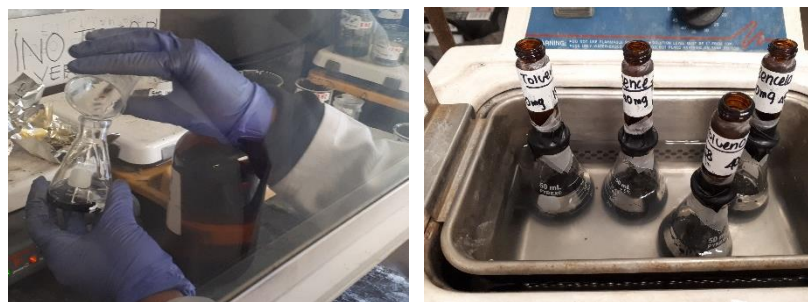
Figura 29. Proceso de oxidación química por medio de ácido nítrico y sulfúrico durante 15 min con sonicación. Este tiempo es necesario para que los nanotubos adquieran propiedades hidrofílicas y pierdan cantidad considerable de imperfecciones.
