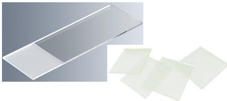
Figura 15. Portaobjetos y cubreobjetos para montar la muestra a analizar por caracterización RAMAN.
