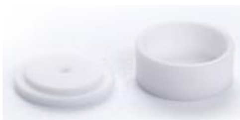
Figura 16. Copa de cerámica para colocar la muestra y caracterizar por medio de TGA.
