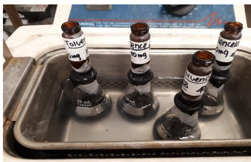
Figura 12. Podemos observar las 4 zonas de la síntesis de NTCMCDN y NTCMC en proceso de oxidación. Sonificados por 15 minutos, logrando disminuir considerablemente la cantidad de imperfecciones (partículas de Fe) y obteniendo NTC hidrófilos.
