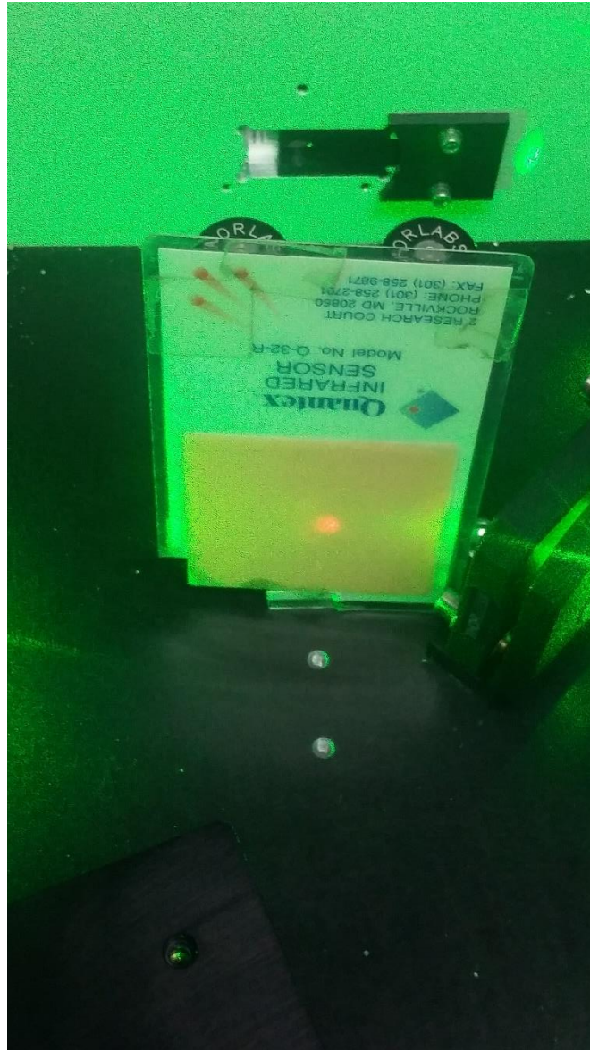
Figura 3. La reflexión del espejo ME (punto brillante) debe de estar corrida hacia la derecha respecto al umbral (mancha de luz) tal como se ve en la figura. El punto brillante es alineado por medio de los controles horizontales y verticales del espejo ME.
