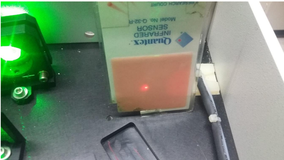
Figura 2. La reflexión del espejo MO (punto brillante) debe de estar corrida hacia la derecha respecto al umbral (mancha de luz) tal como se ve en la figura. El punto brillante es alineado por medio de los controles horizontales y verticales del espejo MO.
