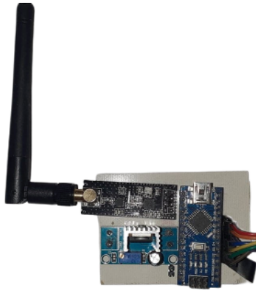
Figura 3.26: Sistema receptor mediante modulo NRF24 y Arduino nano.
