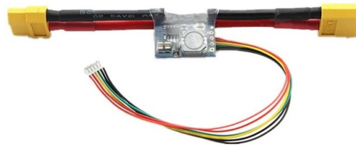
Figura 3.31: Modulo de potencia.
