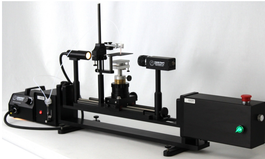
Figura 2.6: Goniómetro ramé-hart (LANIMFE, IF UASLP).
