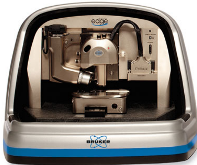
Figura 2.10: Microscopio de fuerza atómica (AFM) Dimension Edge, Bruker ©.
