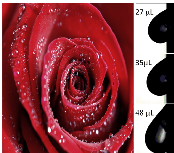
Figura 4.11: Efecto pétalo de rosa sobre superficies de grafeno. Reimpreso con permiso de Elsevier, Copyright © 2017.
