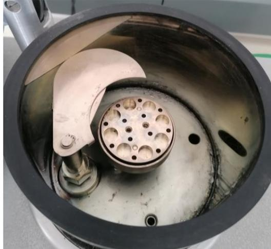
Figura 3.18 Vista interior de la cámara de vacío del equipo de deposición de metal.
