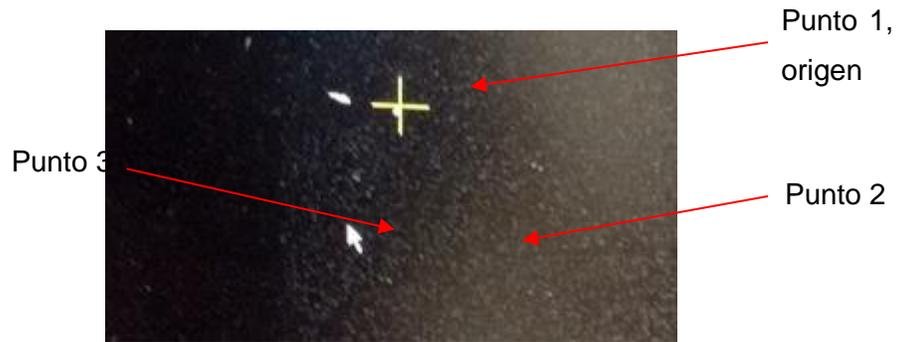
Figura 3.12 Ubicaciones de los puntos para establecer las coordenadas locales en la muestra.
