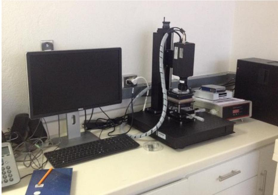
Figura 5.21 Cámara infrarroja, (Optotherm EL InfraSight 320) con una resolución espacial de  $5 \mu\text{m}/\text{pixel}$ .
