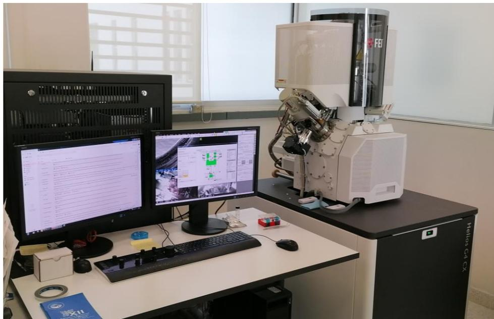
Figura 3.4 Equipo Dual Beam FIB-SEM Helios G4 CX.
