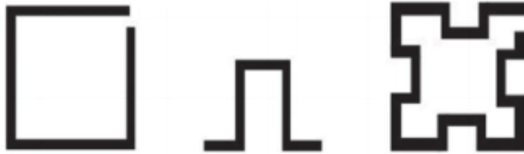
Figura 6.12 Generadores de la geometría fractal del capacitor espiral fractal.
