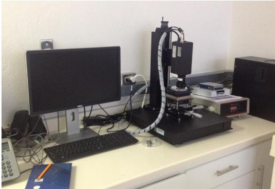
Figura 4.5 Cámara infrarroja, (Optotherm EL InfraSight 320) con una resolución espacial de  $5 \mu\text{m}/\text{pixel}$ .
