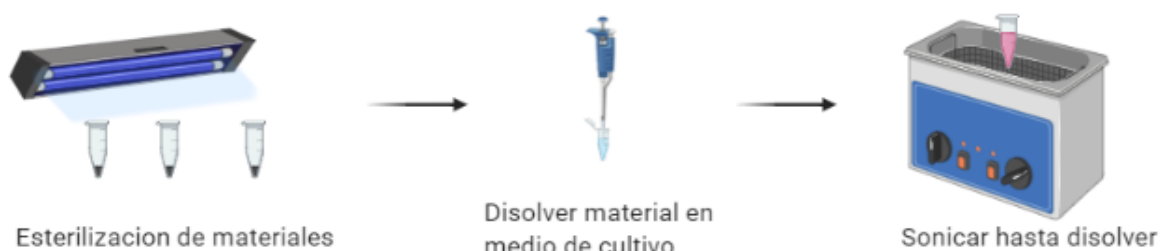
Figura 29. Proceso de preparación de muestras (MWCNT, CS, f-MWCNT) utilizadas en ensayo de resazurina. (Creado con BioRender.com)
